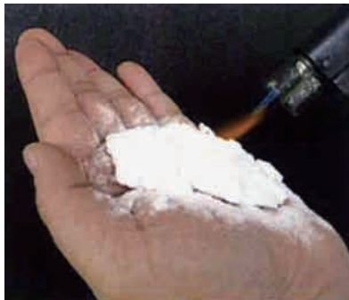
セラミックバルーンの断熱実験 ※安全を確保した中での実験ですので、絶対に真似はしないで下さい。
